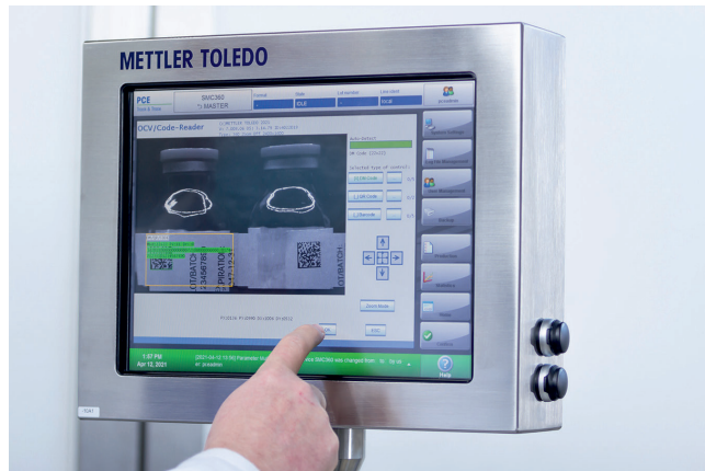
Bild 3. Das Mettler-Toledo System T65 Integrated 360° Aggregation überprüft und aggregiert mittels 360°-Inspektion alle serialisierten Primärprodukte vor dem Befüllen der Sekundärverpackungen. Zusätzliche Prozessschritte wie die Überprüfung von an Boden oder Deckel angebrachten Helper Codes sind somit nicht erforderlich. © Mettler Toledo
